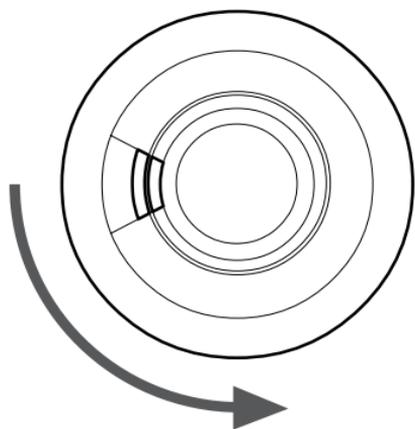
6. Alignez soigneusement le détecteur avec la plaque de montage, puis appuyez doucement sur Home et serrez dans le sens des aiguilles d'une montre.
