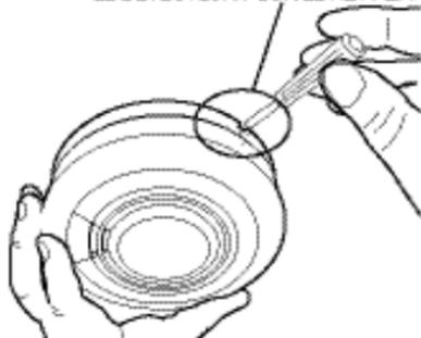
Le cas échéant, il est possible de rendre le détecteur plus sûr en utilisant une vis autotaraudeuse non fournie, d'un diamètre n° 2 ou n° 4 (2 à 3 mm) (1/8 po) et d'une longueur de 6 à 8 mm (1/4 po) (voir la Figure 7d), pour assujettir fermement le détecteur et la plaque de montage ensemble (voir la Figure 7c).
