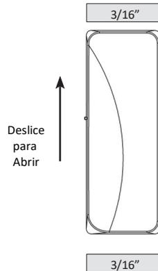
**Instale** quitando el papel adhesivo y pegando el sensor y el imán en una puerta o ventana. Deja un mínimo de 5 mm alrededor de los extremos del sensor para permitir que se abra la tapa. Asegúrese de alinear las marcas de alineación en el sensor y el imán al montarlo.
